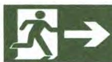
Indicação do sentido (esquerda ou direita) de uma saída de emergência, especialmente para ser fixado em colunas. Dimensões mínimas: L = 1,5H.
