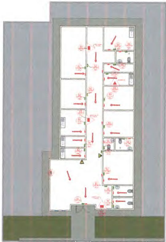
1 PLANTA DE COMBATE A INCENDIO 1:100
