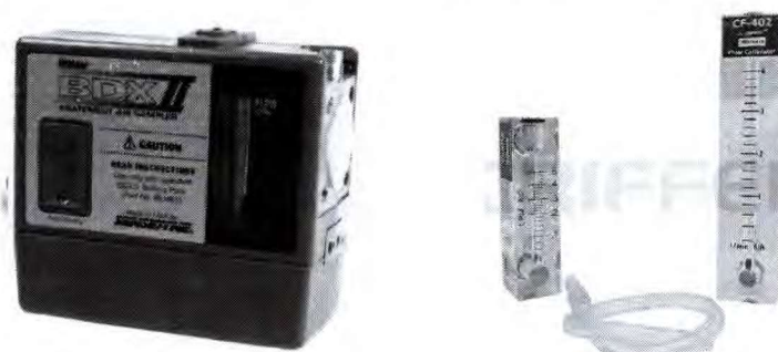
Figura 04: Bomba de Amostragem Sensidyne modelo BDX II e Calibrador de Fluxo Analógico Criffer modelo CF 402
